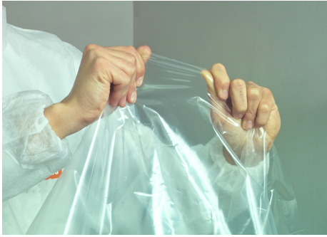
Bild 1: kraftvoller Zug - Handreißtest
