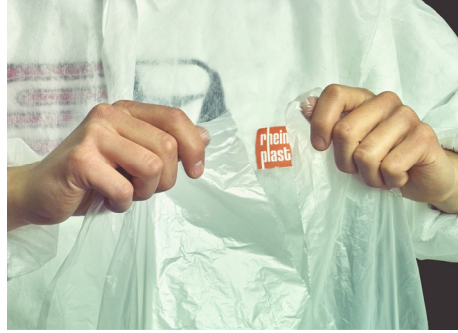
Bild 2: Rissverlauf bei geringer Zähigkeit
