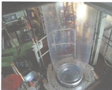
Herstellung: Die Folien werden ausgeblasen ...
