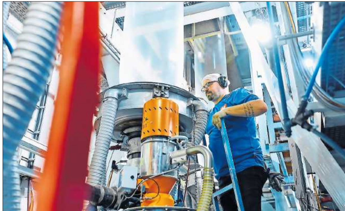
Neue Beutel entstehen: In der Blasfolien-Extrusion beim Folienhersteller Rhein-Plast.
